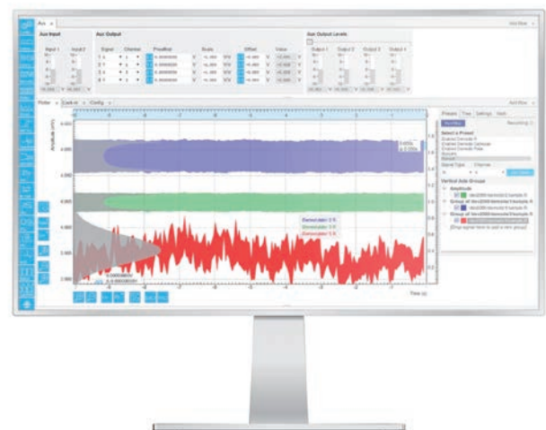
図15：Zurich InstrumentsのロックインアンプのLabOne®ユーザーインターフェースは、最新のウェブブラウザ技術を採用しています。複数のPCやタブレット端末などの複数のブラウザセッションから、同時に機器を制御することができます。すべての信号解析および制御ツールには、専用のタブが用意されており、ブロック図を用いた表示等により、直感的に操作できます。
